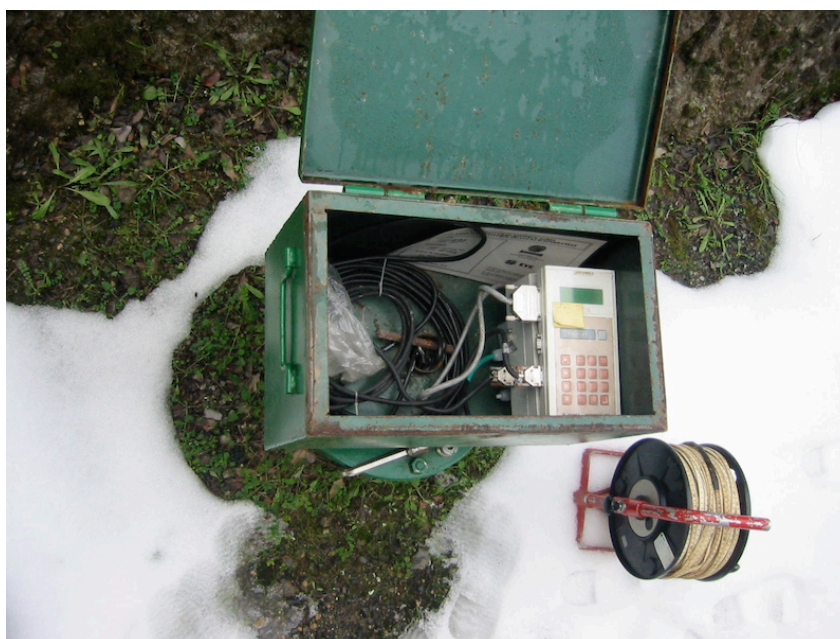
2.2.irudia- Kontrol piezometrikorako estazioa (SP07-MAÑARIA-2 zundaketa)
