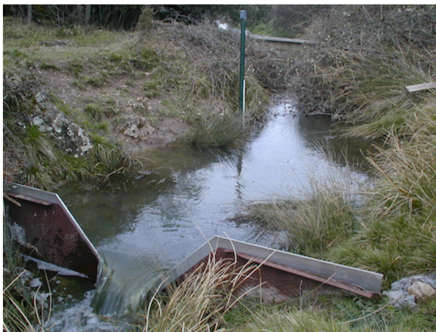
6.1. Irudia- Arreo Irteera aforo-estazioa (90ºtako hiruki formako isuribideduna)
