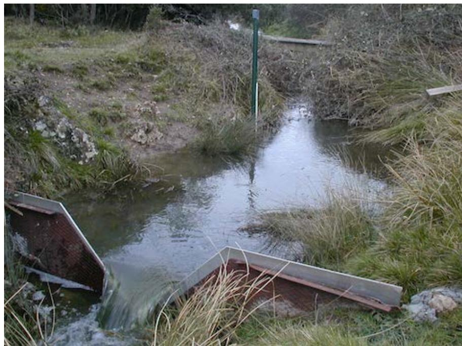
Fig. 6.1.- Aspecto de la estación de aforo Arreo Salida (Vertedero Triangular 90º)
