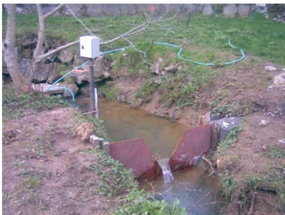
Fig. 7.1.- Aspecto de la estación de aforo del manantial Angela (Vertedero Triangular 60°)
