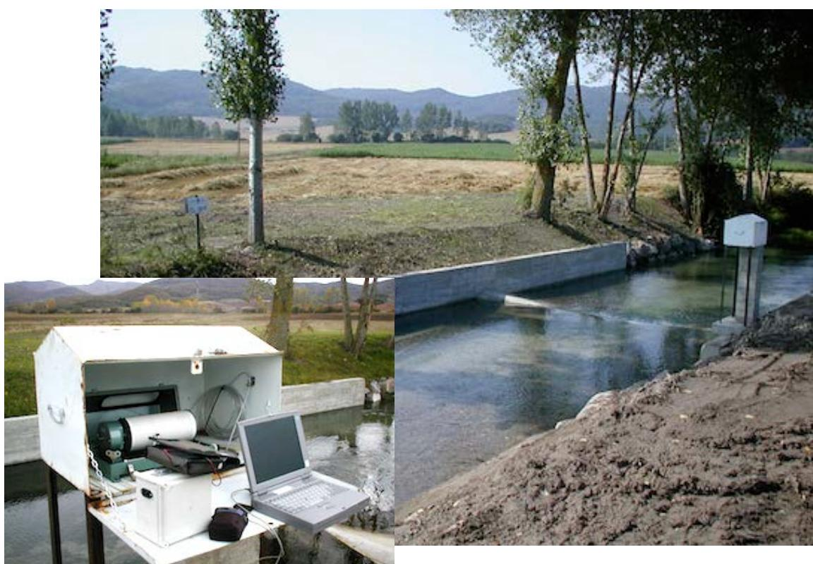
Fig. 2.1.- Estación de aforo tipo. Vertedero Crump-modificado (SA01-Manantial Peñacerrada)
