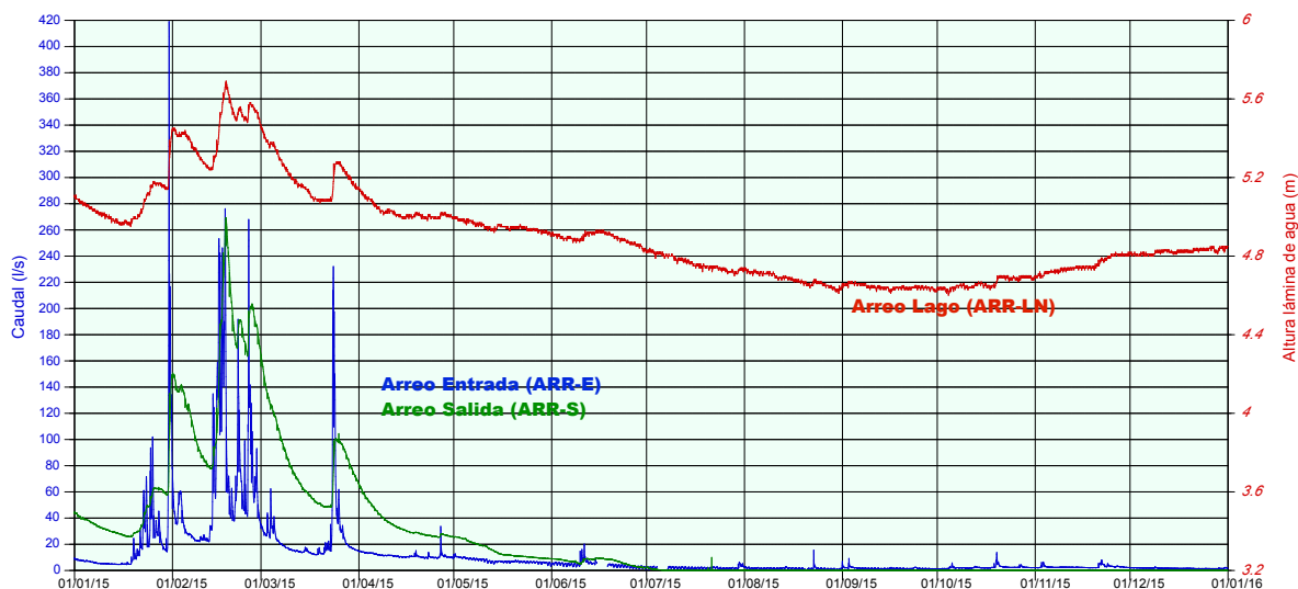
Fig. 6.2.- Evolución gráfica del nivel y de los caudales en el lago Arreo (2015).
