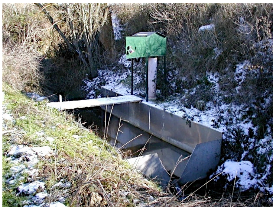
Fig. 6.1.- Aspecto de la estación de aforo Arreo Entrada (Vertedero Triangular 90°)
